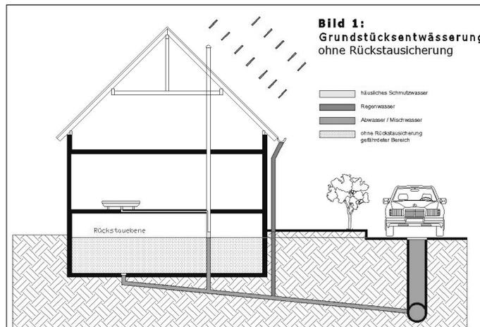
Bild 1: Grundstücksentwässerung ohne Rückstausicherung
